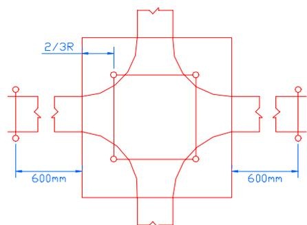
图 4.5.4 - 2 水平四通支吊架
