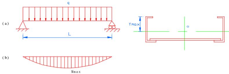
图 A.0.1 - 1 托盘、梯架的荷载及弯矩图 图 A.0.1 - 2 托盘、梯架的横截面
