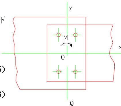
图 A.0.8 受剪螺栓群配置
