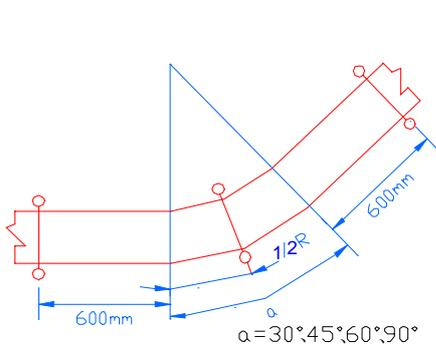
图 4.5.3 水平弯通支吊架
