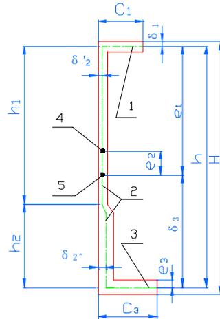
图 A.0.4 梯架一个侧边的计算示意图
