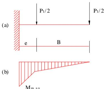
图 A.0.6 - 1 托臂荷载及弯矩图
