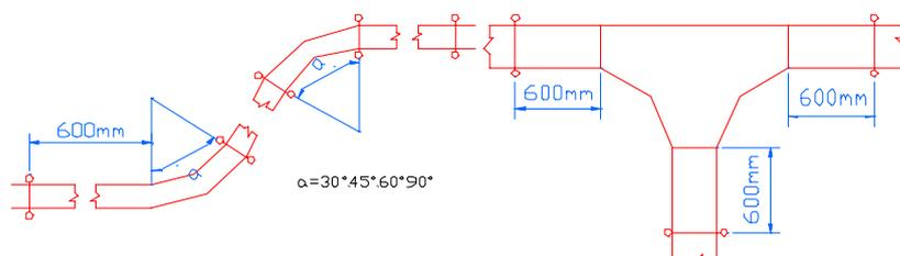
图 4.5.6 垂直弯段支吊架
