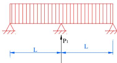
图 A.0.6 - 2 托盘、梯架作用于托臂的总支承力
