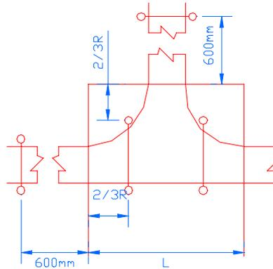
图 4.5.4 - 1 水平三通支吊架
