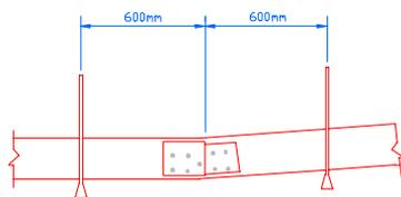
图 4.5.5 垂直铰接板支吊架
