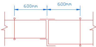
图 4.5.2 - 1 变宽板支吊架
