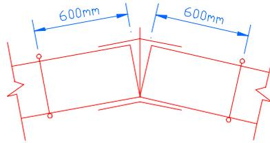
图 4.5.2 - 2 水平铰接板支吊架
